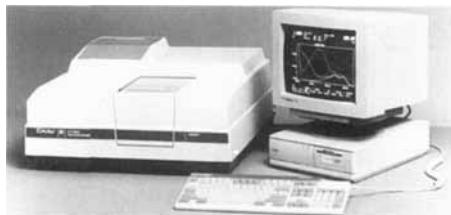
Methoden Protein-Konzentration, Kinetik-Rekorder, DNS/RNS-Bestimmung, Mehrwellenlängenkinetik und vieles mehr. Das Programm steuert den Ablauf der Messungen und kontrolliert einen Wechsler für 12 Küvetten, der in das Spektralphotometer eingebaut ist.
