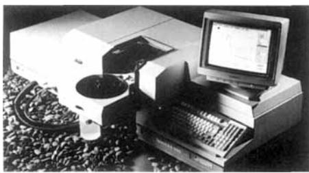
genoptimierung vereinfachen das Einstellen der Parameter des Gerätes und den Analysenbetrieb. Die „Very Fast Furnace“-Technik ermöglicht am SpectrAA-600 bis zu zwei Graphitrohrmessungen in einer Minute, d.h. dieses AAS analysiert bis zu dreimal schneller als konventionelle Graphitrohrsysteme. Das verwendete OS/2-Betriebssystem ist multitaskingfähig.
